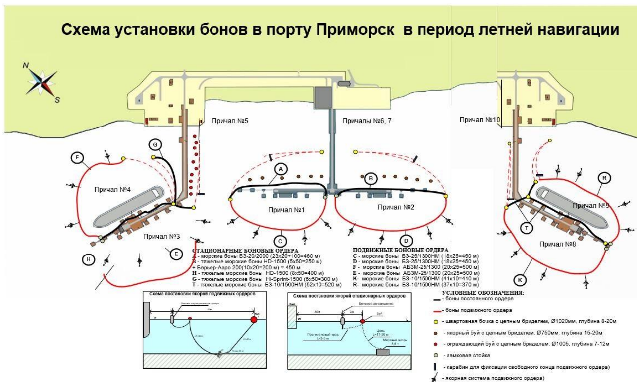
Рисунок 6.1 – Схема установки бонов в порту Приморск в период летней навигации
